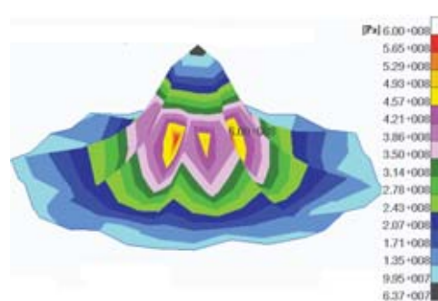
Rys. 15. Mapa wyężenia dla elementu energochłonnego o podstawie ośmiokątnej
