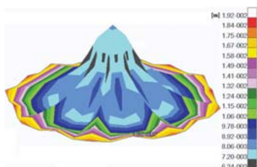
Rys. 14. Deformacja struktury w kształcie ostrosłupa o podstawie ośmiokątnej
